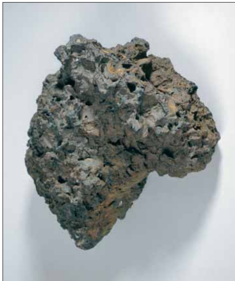
Slagglump frå jernsmelting.
