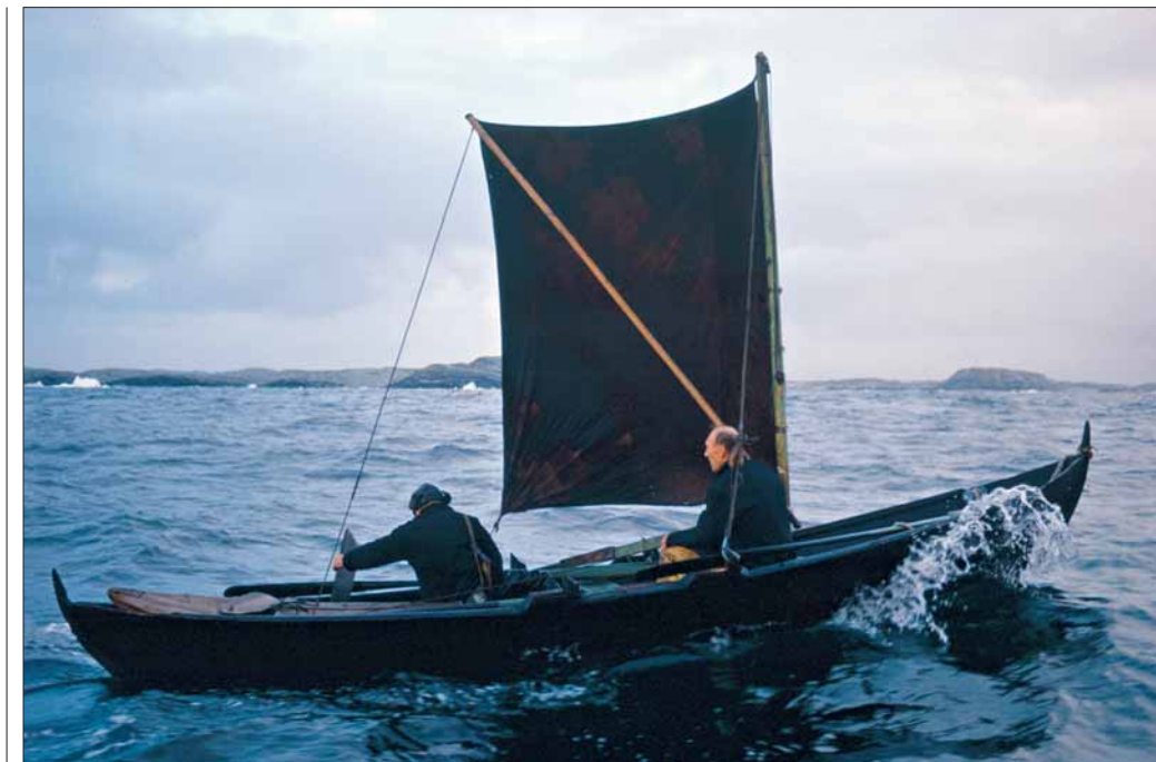
Oselveren er også en glimrende seilbåt, først og fremst på grunn av bunnsformen med hogne «halser», men den krever et dyktig mannskap (©410)
