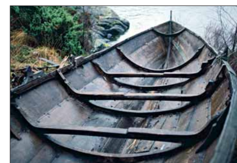
Oselver. Legg merke til de brede bordgangene og de naturvokste spantene.
